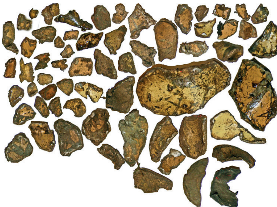
Rys. 33. Część zebranych odłamków ze śladami oddziaływania termicznego.
