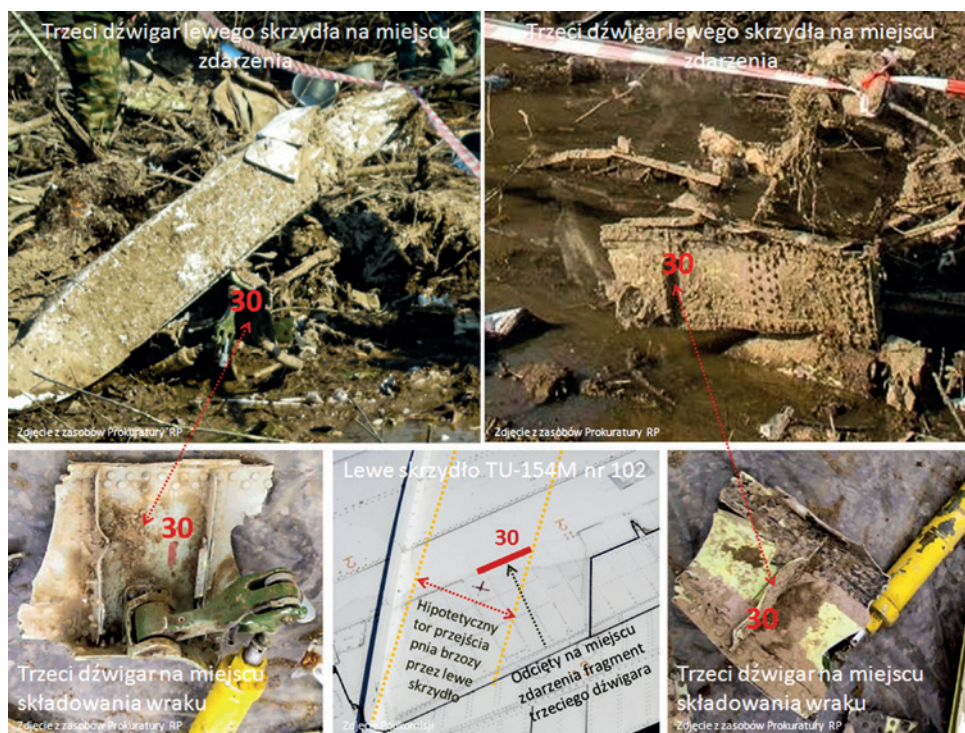
Rys. 15. Widoki tego samego fragmentu dźwigara nr 3 odejmowanej części lewego skrzydła na głównym polu szczątków i miejscu składowania odłamków.
