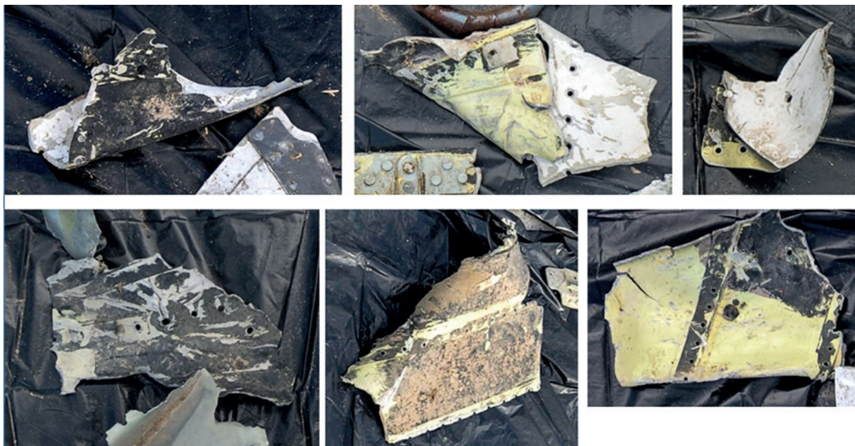
Rys. 10. Odłamki poszycia spodniego wywinięte na zewnątrz konstrukcji.
