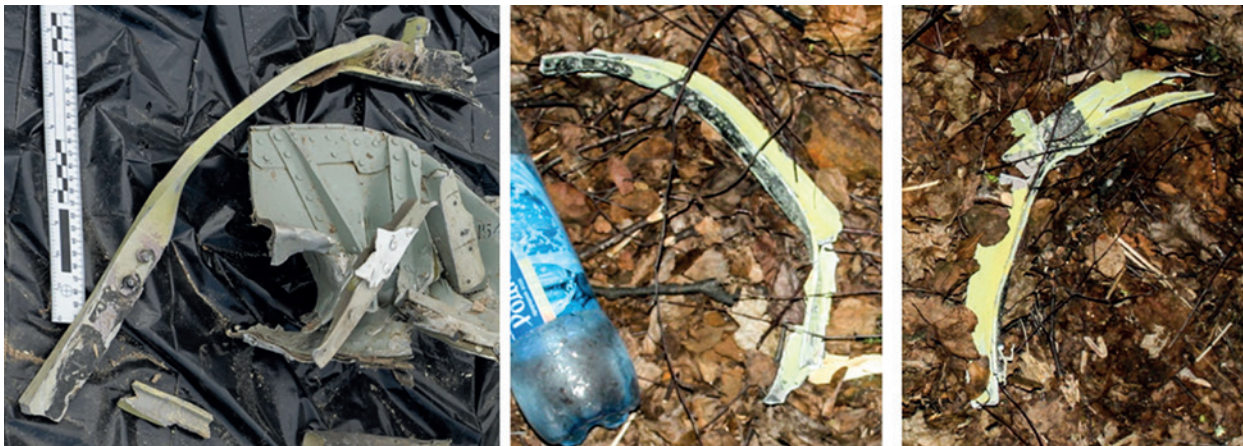
Rys. 8. Odłamki podłużnic wywiniętych na zewnątrz konstrukcji.
