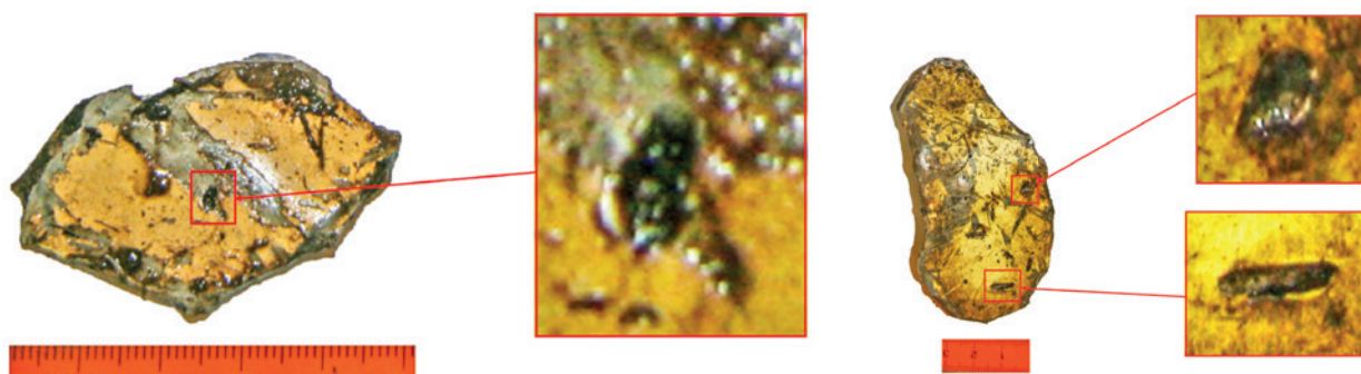
Rys. 34. Porównanie mikrokraterów na powierzchni odłamków odnalezionych przez archeologów i odłamkach powstałych po eksperymencie pirotechnicznym przeprowadzonym przez Podkomisję.
