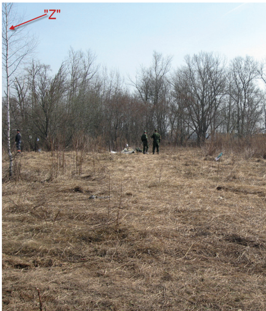
Rys. 30. Drzewo zaznaczone literą „Z” rosnące bezpośrednio pod torem lotu, kiedy samolot leci z ulicy Kutuzowa (w tle) do miejsca upadku. Z prawej jest widoczny ślad na ziemi (południowy wykrot) uderzenia lewym statecznikiem w ziemię.
