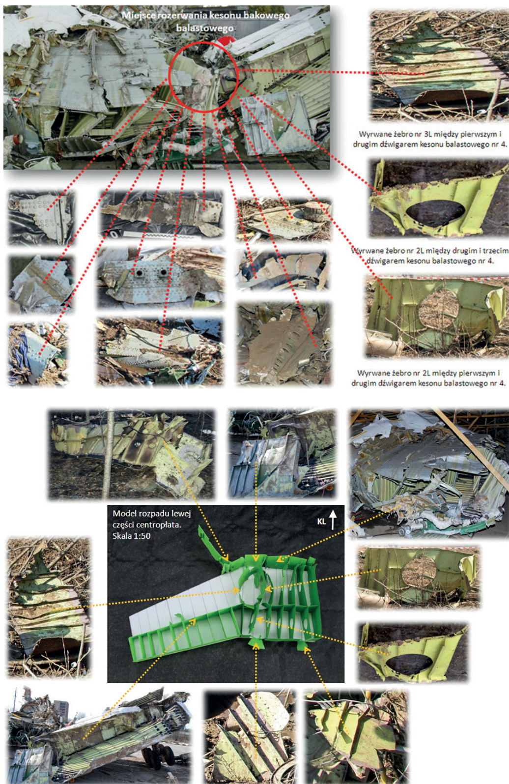
Rys. 38. Miejsce rozerwania kesonu balastowego. Opracowanie własne Podkomisji.
