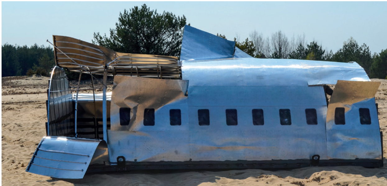
Rys. 51. Wybuch paliwa lotniczego w modelu części pasażerskiej samolotu.
