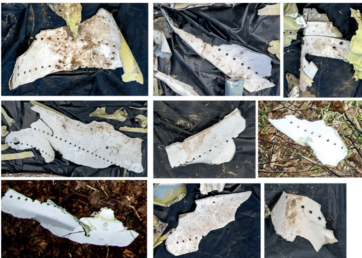
Rys. 9. Odłamki poszycia wierzchniego wywinięte na zewnątrz konstrukcji.
