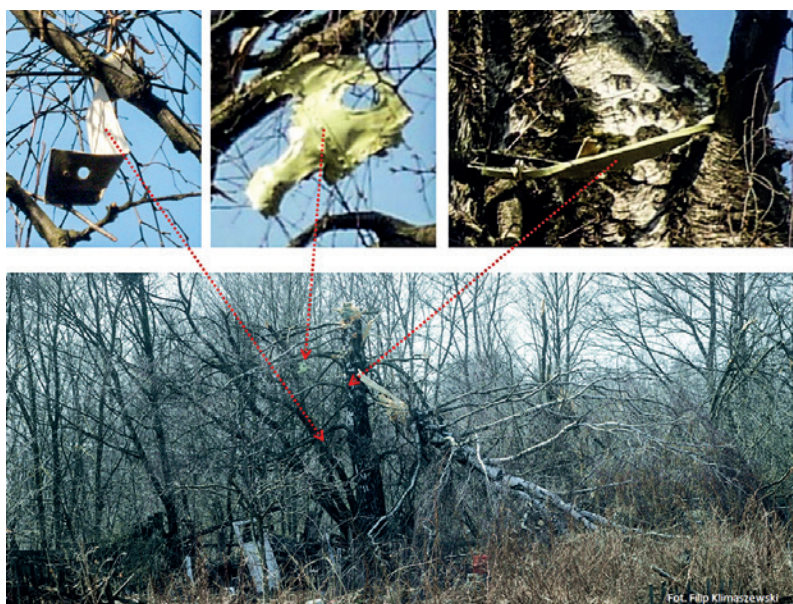
Rys. 4. Zidentyfikowane odłamki odejmowanej części lewego skrzydła wiszące 10.04.2010 r. na gałęziach (bb).
