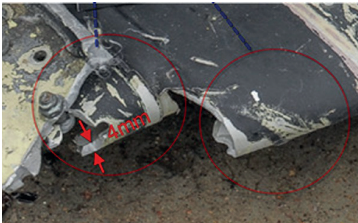
Rys. 22. Przybliżenie zdjęcia z Rys. 21 z uwidocznieniem loków powybuchowych.
