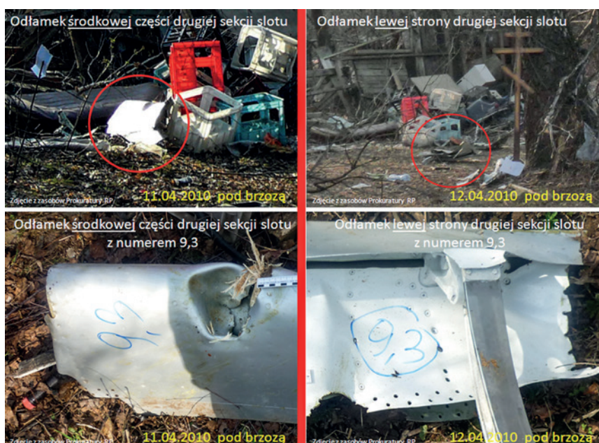
Rys. 19. Odłamki 2 sekcji slotu przenieszone pod (bb) i zamieniane miejscami.
