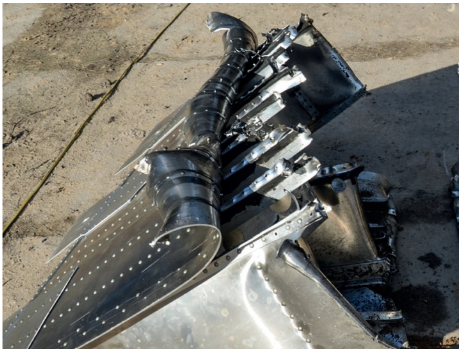
Rys. 23. Skala 1:1. Efekt eksperymentu rozcięcia modelu skrzydła z paliwem przy użyciu materiału wybuchowego.
