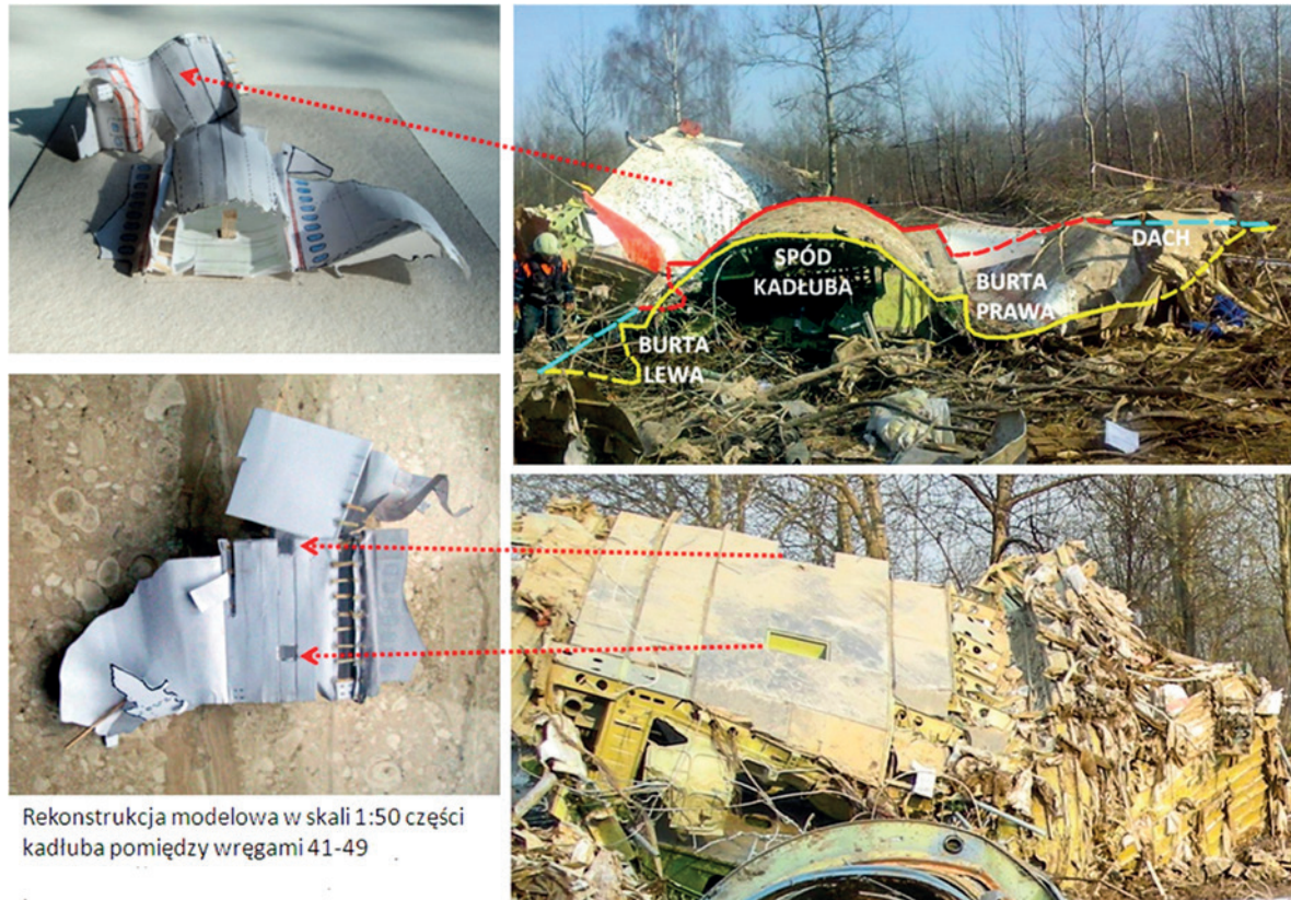
Rys. 44. Obraz zniszczenia części kadłuba z burtami otwartymi na obie strony.
