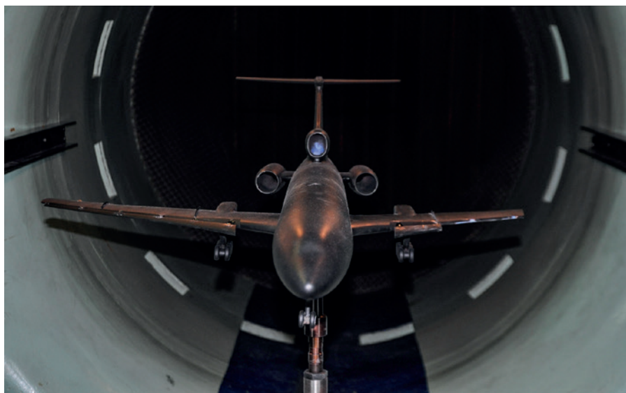
Rys. 25. Model samolotu w tunelu aerodynamicznym Instytutu Lotnictwa.
